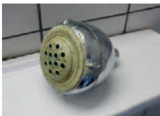
▲ Duschkopf – links mit starken Kalkablagerungen, rechts nach der Behandlung
